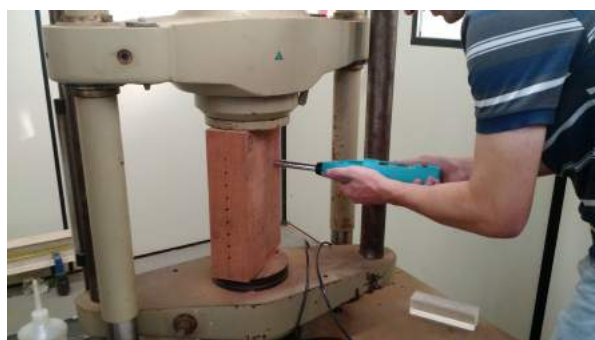
Figura 1. Esclerometria aplicada em prisma comprimido.
