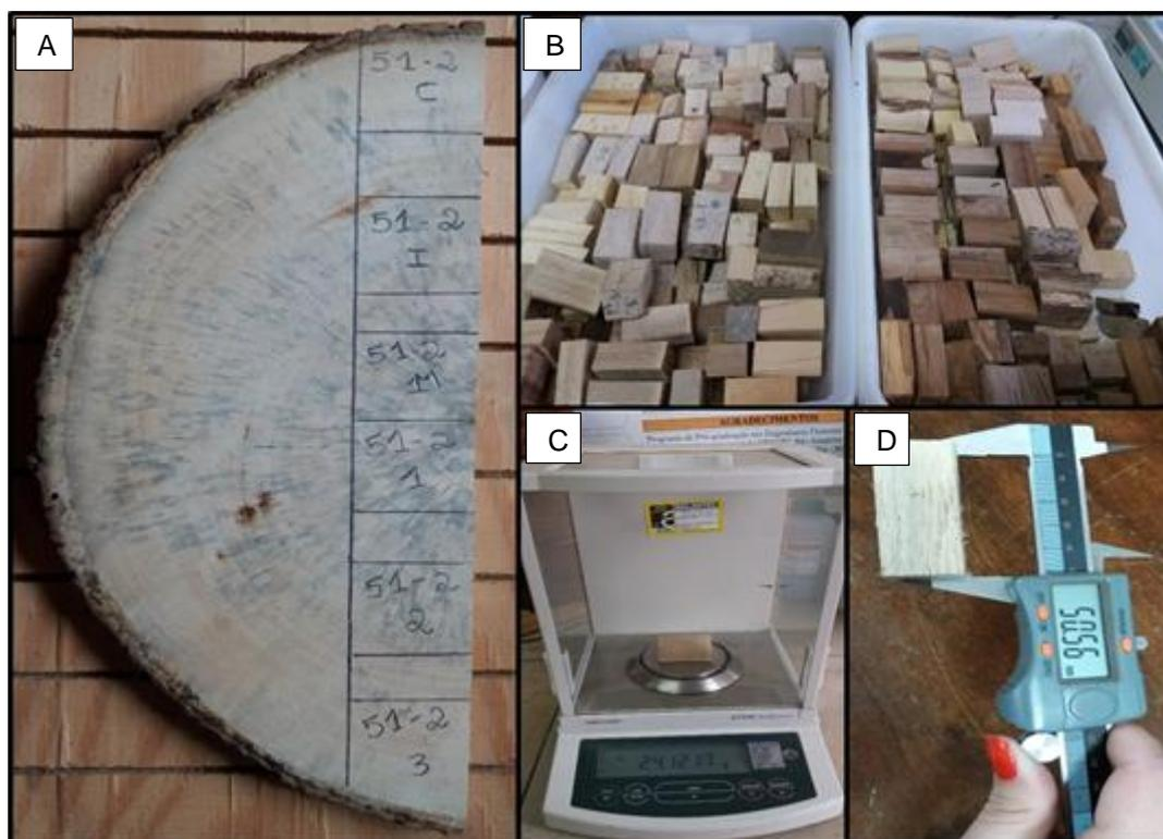
Figura 4. Obtenção da densidade aparente pelo método estereométrico. (A, B) Corpos-de-prova; (C) Obtenção da massa com balança de precisão; (D) Obtenção do volume pelas medidas de todas as dimensões do corpo de prova com auxílio de paquímetro.
