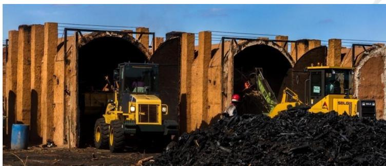
Figura 1. Forno retangular para a carbonização de madeiras.
