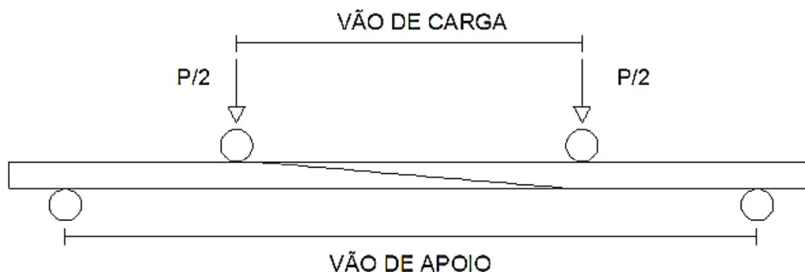
Figura 2. Ensaio de flexão à quatro pontos
