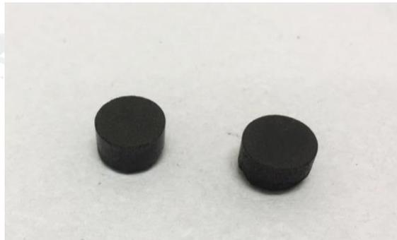
Figura 1. Amostras do compósito W5%Lig, homogeneizada e prensada com 5 t.
