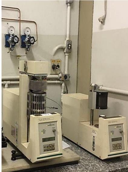
Figura 2. Equipamentos de análise termogravimétrica TG e DSC, INFI/UFMS.
