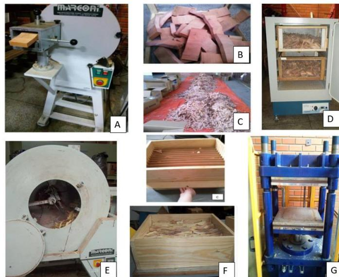
Legenda: A) Máquina geradora de partículas B) Peças destopadas C) Partículas geradas secando ao ar D) Secagem das partículas em estufa a temperatura de 80°C até atingirem teor de umidade aproximado de 4% E) Encoladeira para aplicação da resina e parafina F) Caixa formadora para orientação das partículas G) Prensagem
