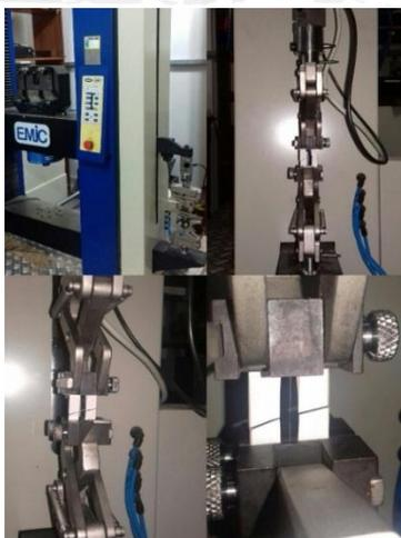
Figura 2. Disposição do corpo de prova na máquina.
