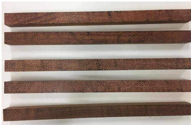
Figura 1. Corpos de prova marcados com partículas feitas de forma aleatória
