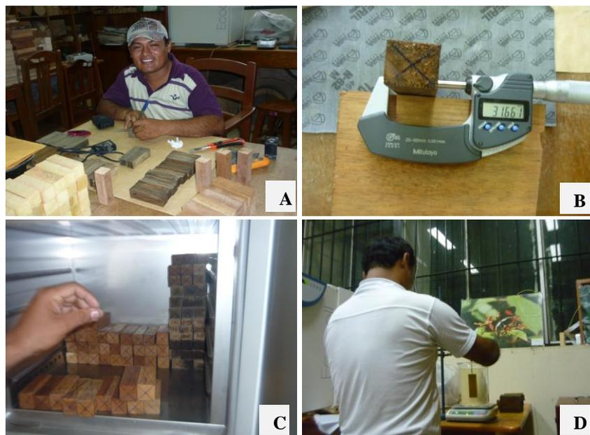
**Figura 1.** Propriedades físicas das quatro espécies: **A.** Codificação das amostras; **B.** Micrômetro digital para as mensurações; **C.** Estufa com as amostras; **D.** Obtenção do volume das amostras.
