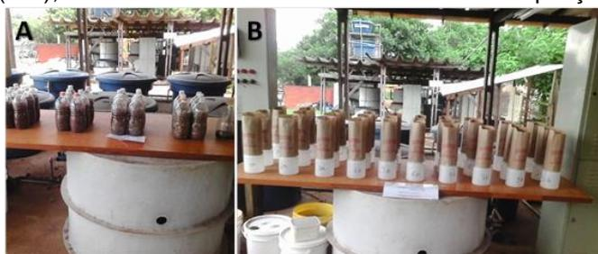
**Figura 1.** A) Vermifiltros construídos em garrafas PET e dispostos na bancada com diferentes substratos; B) Vermifiltros com recipientes plásticos para a coleta do drenado.
