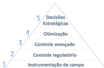
Figura 1: Representação da pirâmide de controle de processo. Adaptado de Strutzel [2014].
