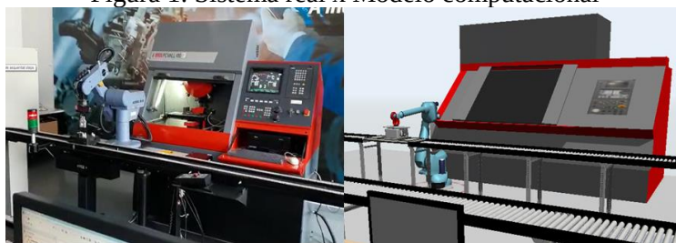
Figura 1: Sistema real x Modelo computacional
