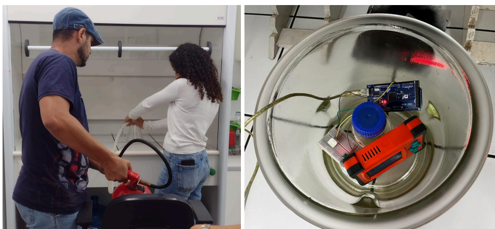
Figura 2: Realização do teste de concentração de CO 2 e equipamentos no recipiente.
