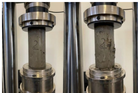
Figura 4: Ensaio de resistência à compressão do concreto [O Autor].
