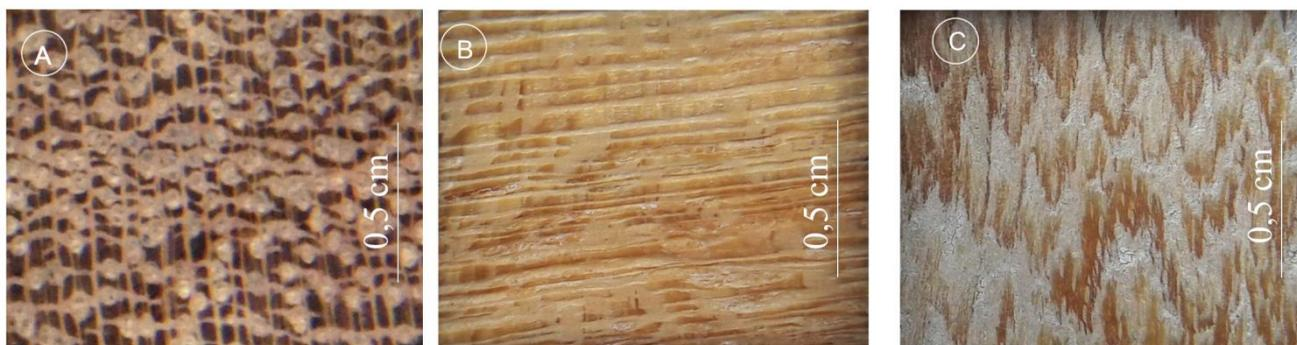
Figura 1 - Faces do corpo de prova de *V. guianenses*: A- Transversal; B- Radial; C- Tangencial.
